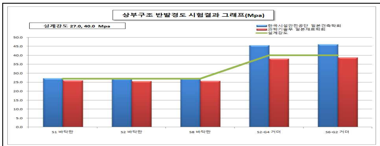
【그림 16.4.2】 상부구조 반발경도시험 측정결과
